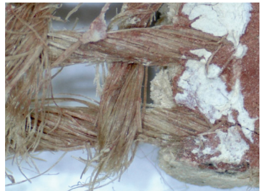
Geflecht mit Fasern und Mörtel bei 40-facher Vergrößerung
