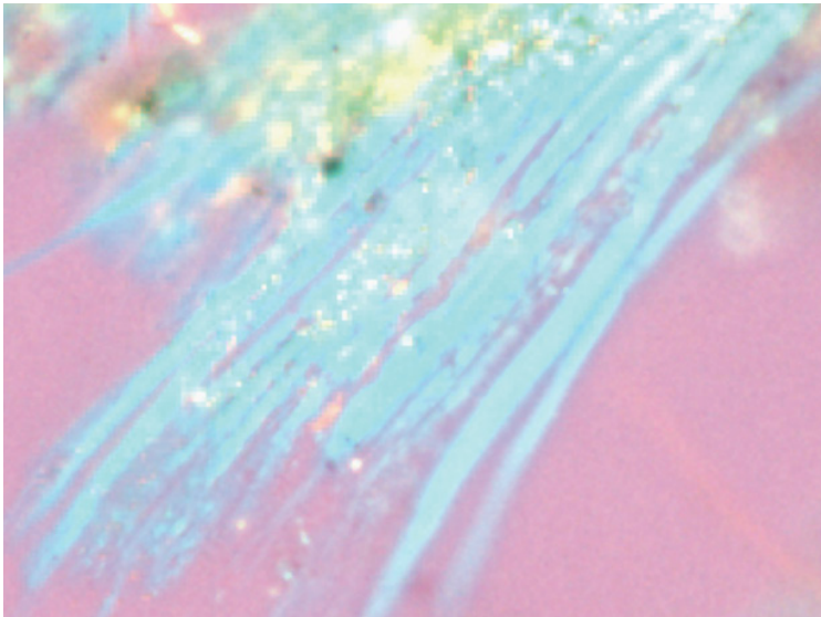
Asbestfasern eines Dämmstoffes (Polarisationsmikroskop, Vergrößerung 400x)
