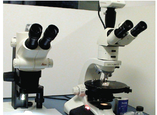
Baustoffprüfung mit Stereomikroskop und Durchlicht-/Polarisationsmikroskope von Leica
